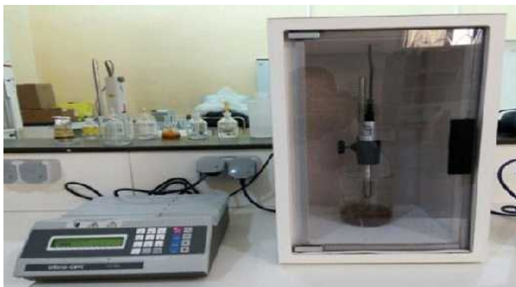
Figure (III.2) : Schéma du dispositif du bain ultrason
