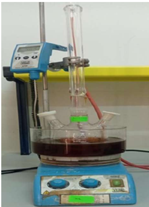
FIGURE I1: Schéma et montage de synthèse organique à reflux
