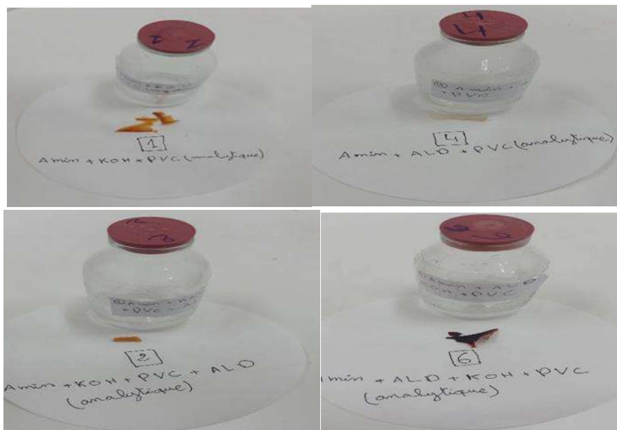
FIGURE III 1 : Solution d'eau de plomb après élimination du PCV modifié
