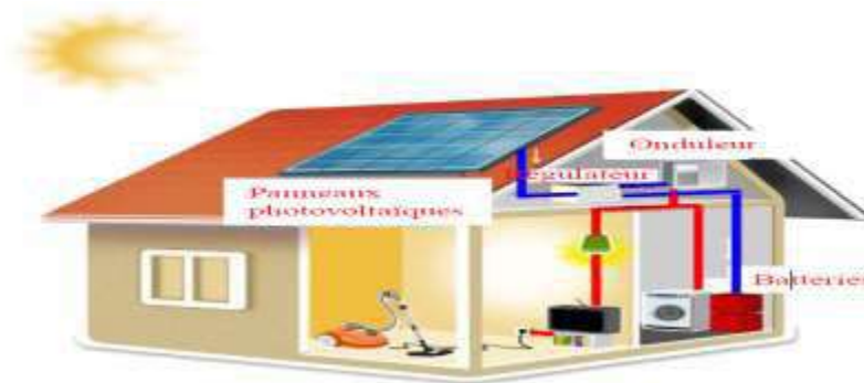
Figure. (I.12): Installation sur site isolé
