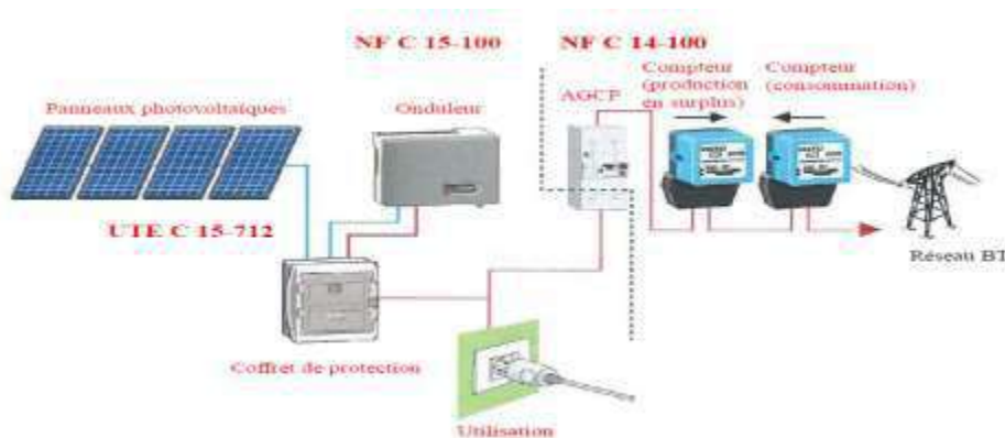
Figure.(I.16) : Injection énergie supplément dans le réseau
