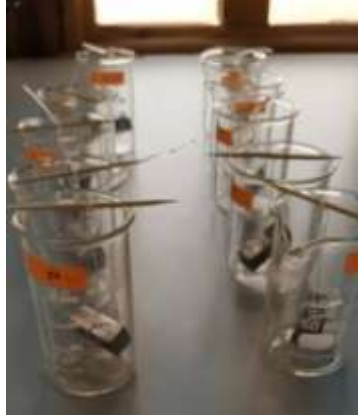
الشكل (III-16) : غمس قطع الفولاذ في المحاليل مختلفة التراكيز
