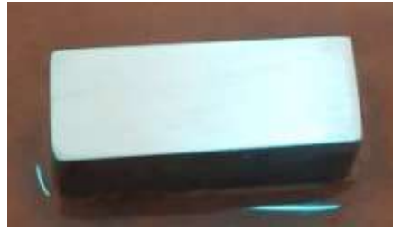
الشكل (III-7) : عينة من الفولاذ (X70)
