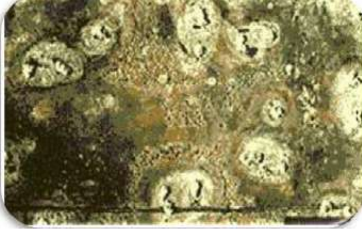
الشكل (1-3) : صورة للتآكل بالنقر [50]
