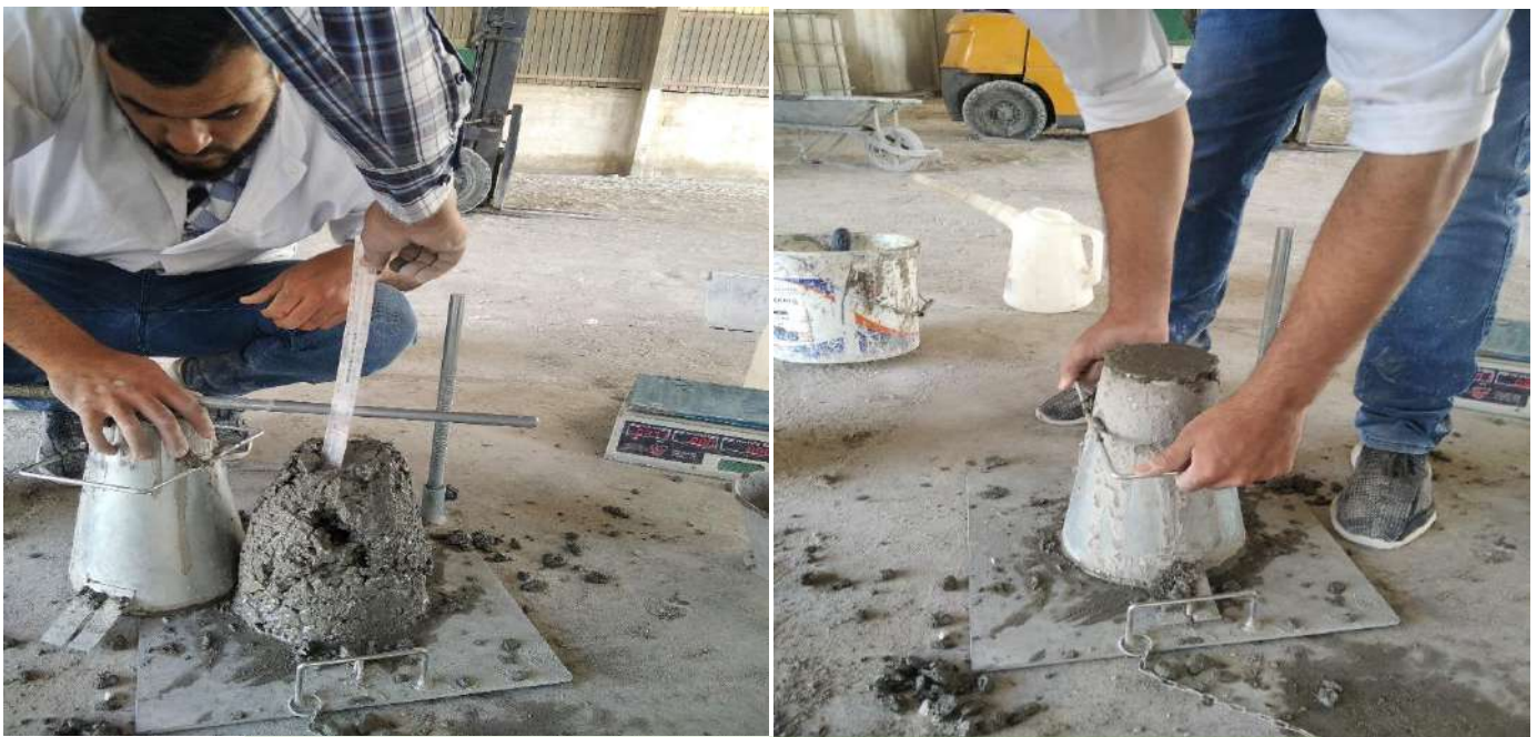
Photo III.2 : L'essai de l'ouvrabilité au Cône d'Abrames
