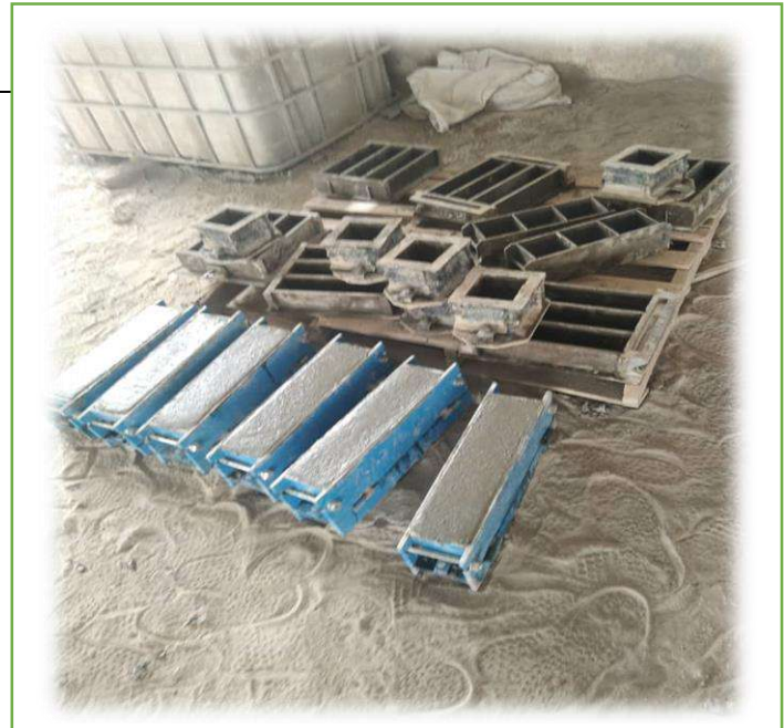
Photo III.6: Eprouvette après coulage
