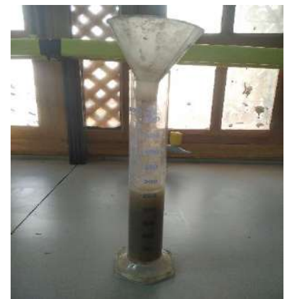
Photo II.3: L'essai de équivalent de sable
