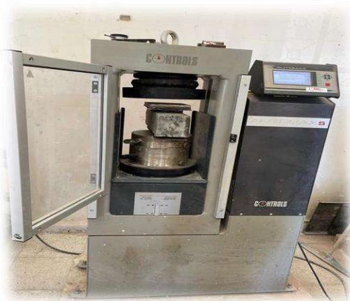
Photo (IV.1) : L'appareil de traction et compressions
