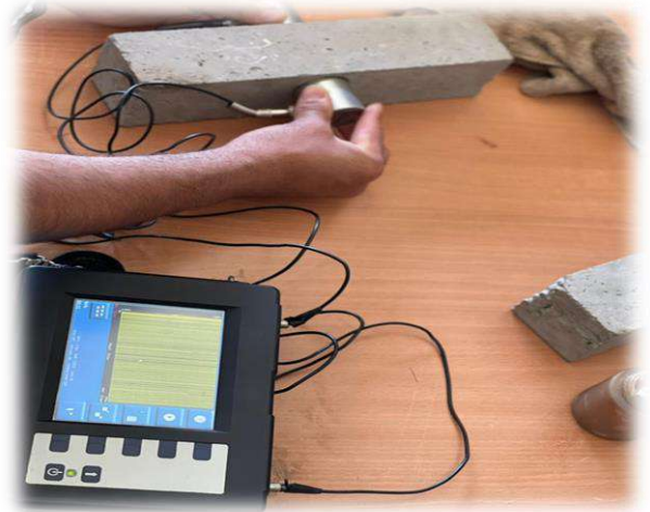
Photo (IV.5): Essai de ultrason
