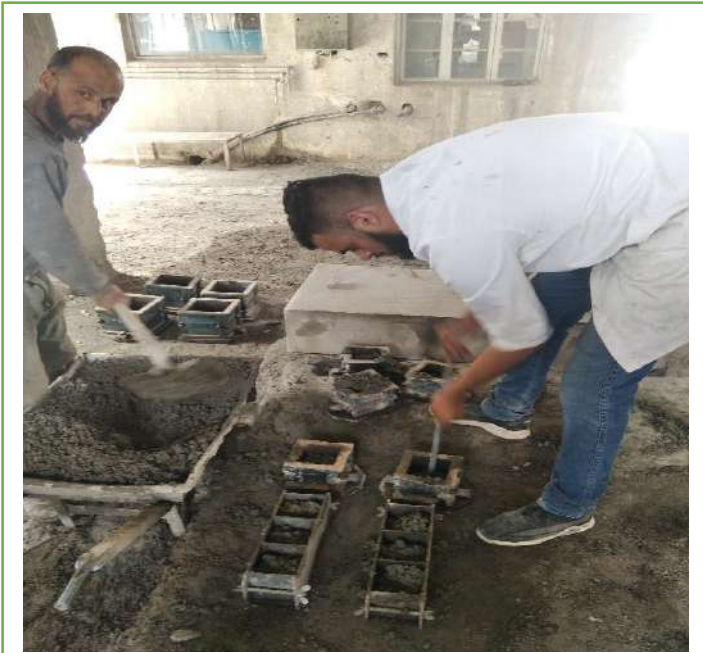
Photo III.5 : Fabrication des éprouvettes
