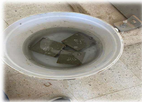
Photo (IV.6) : Essai l'absorption de d'eau d'eau
