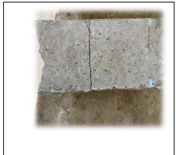
Photo(IV.3) : Eprouvette après essai compression
