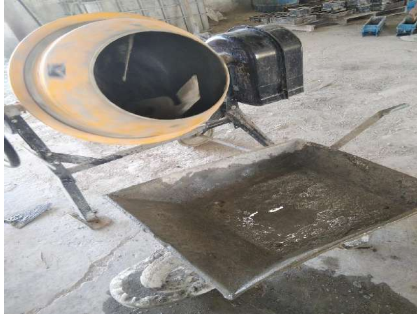
Photo III.1 : Malaxeur de Béton 30litre
