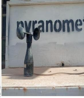
جهاز قياس سرعة الرياح
