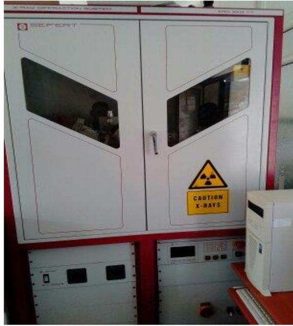
الشكل 22: جهاز إنعراج الأشعة السينية المستخدم
