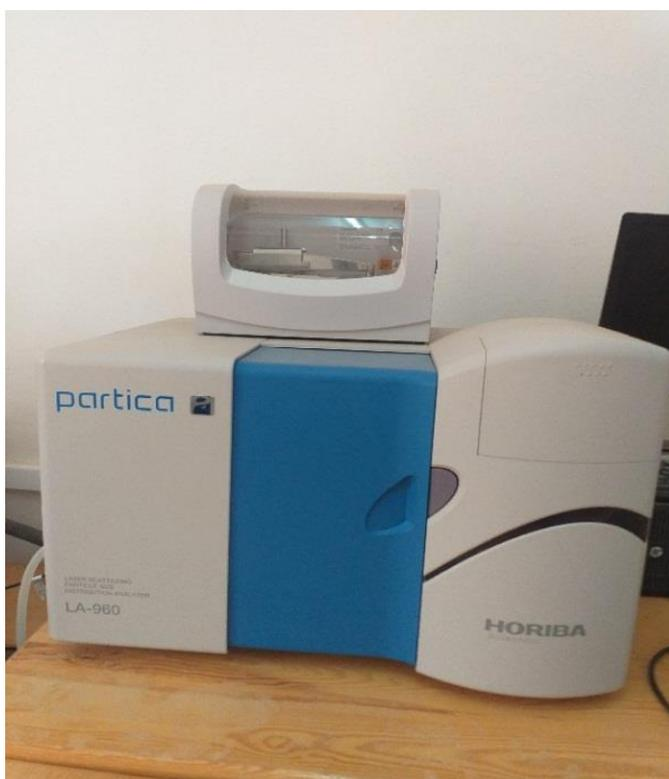
الشكل 13: الجهاز المستعمل لقياس قطر حبيبات المسحوقين
