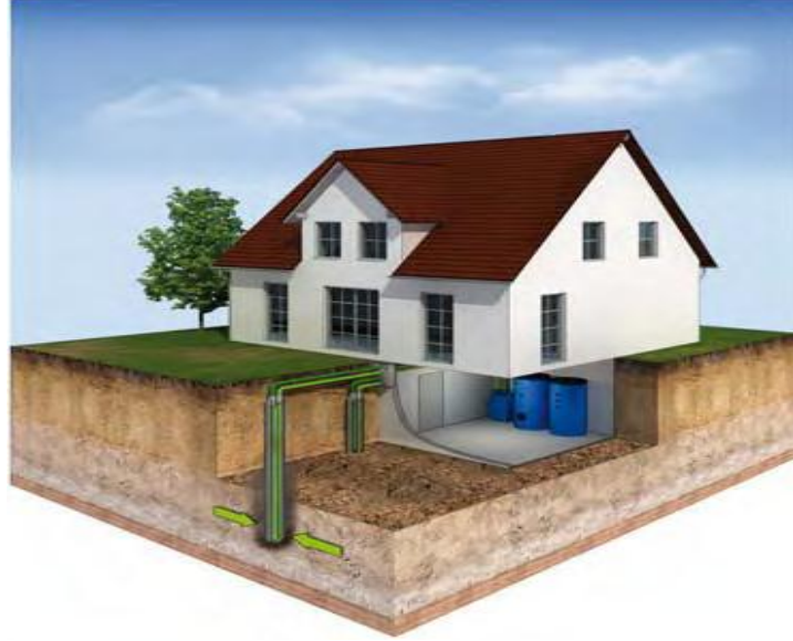
الشكل (2-2): مبادل حراري عمودي [3]
