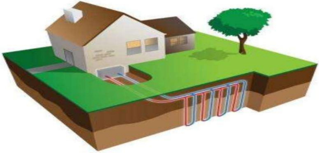
الشكل (2-5): مبادل حراري ملفوف [24]
