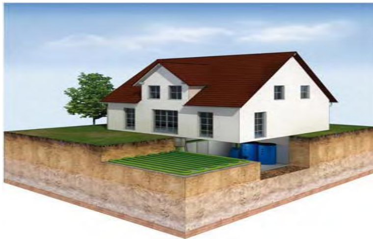
الشكل (2-3): مبادل حراري أفقي [3]
