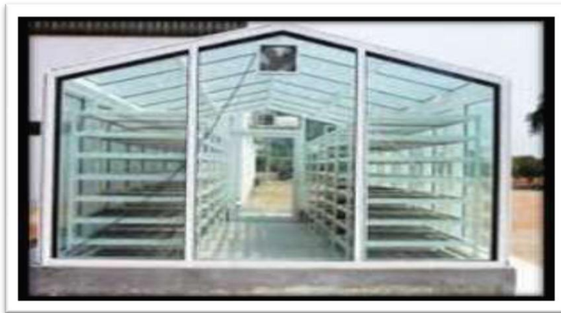
الشكل (5-1): استعمال الطاقة الشمسية في التجفيف المحاصيل الزراعية [20].
