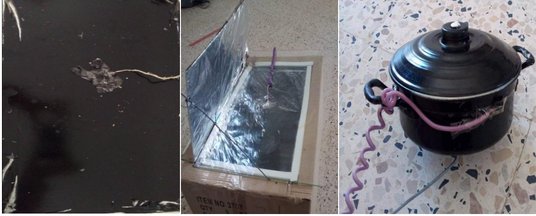
الشكل (3-13): كيفية توصيل المزدوج الحراري بالأدوات المستعملة في الطباخ الشمسي.
