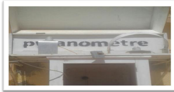
الشكل (1-3): جهاز البيرانومتر (pyranometre) لقياس شدة الإشعاع.
