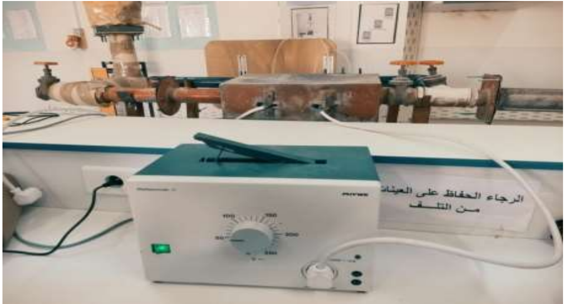
Figure (4.9) transformateur variable
