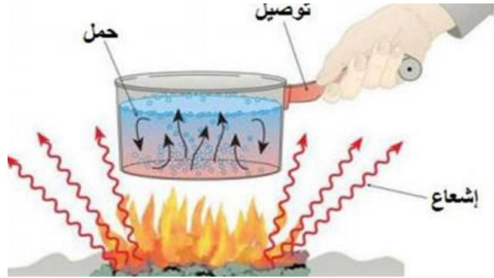
شكل رقم (1.1): يوضح طرق انتقال الحرارة [4]
