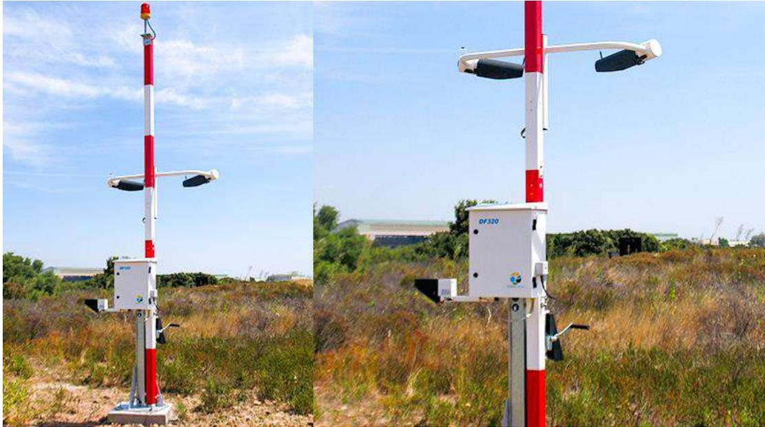
الشكل (II-10) : مقياس الرؤية DF320 لشركة Degreane-Horizons [42]
