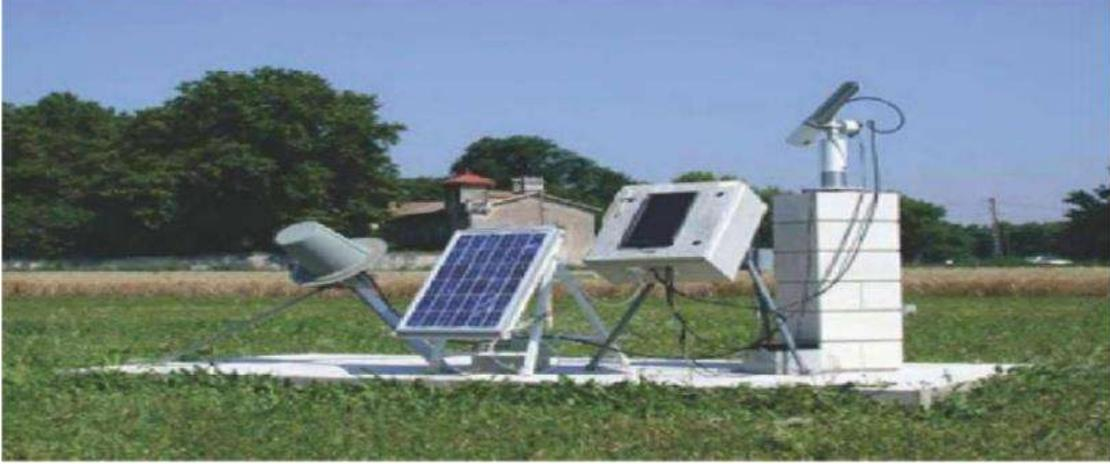
الشكل (II-7): جهاز (SUN-PHOTOMÈTRE) المستخدم في شبكة AERONET. [1]
