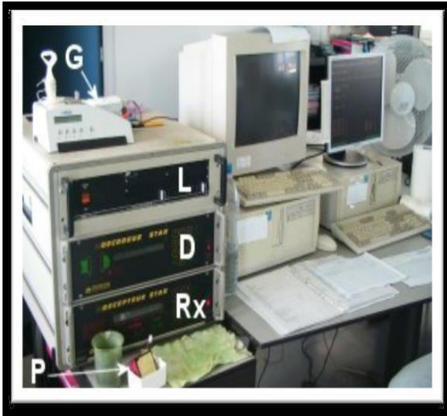
Figure (I.11) : Poste de suivi de radiosonde VAISALA [2]
