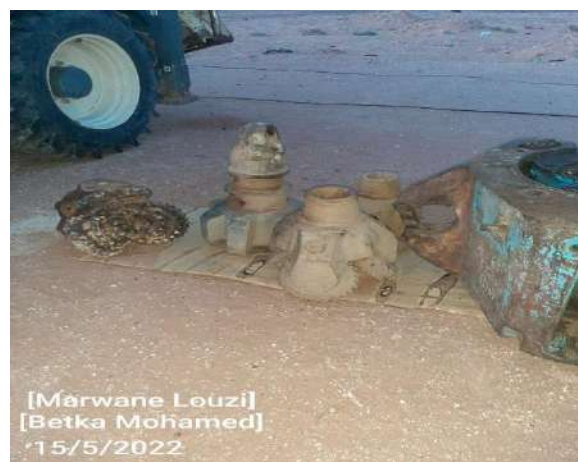
Figure N°11 : L'outil de forage
