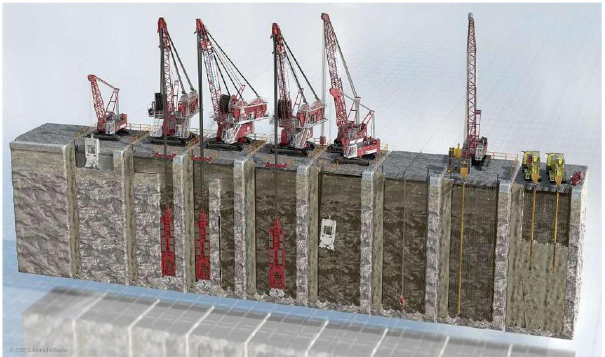
**Figure I.17 :** Schéma des étapes de réalisation d'une paroi moulée.
