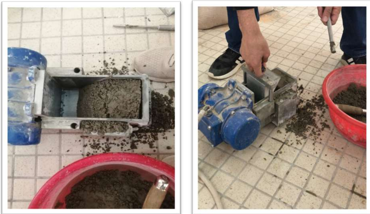
Photo 2.6: Essai de Maniabilimètre
