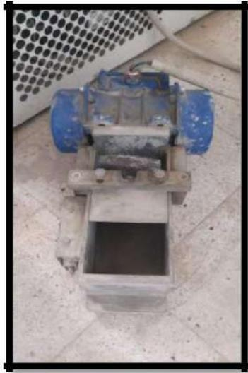
Photo III.1 Appareillage de l'essai de la maniabilité
