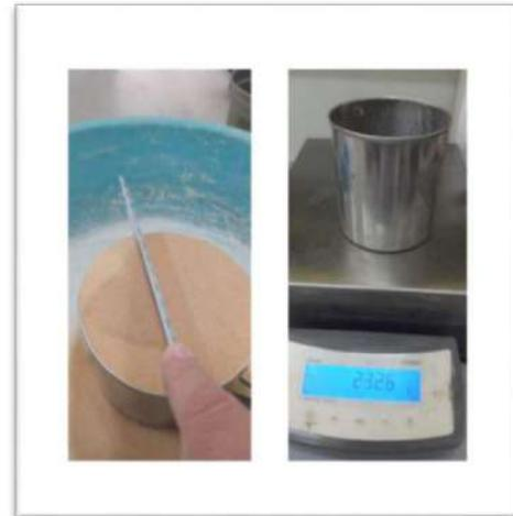
Photo II.2 La masse volumique Apparente du sable de dune
