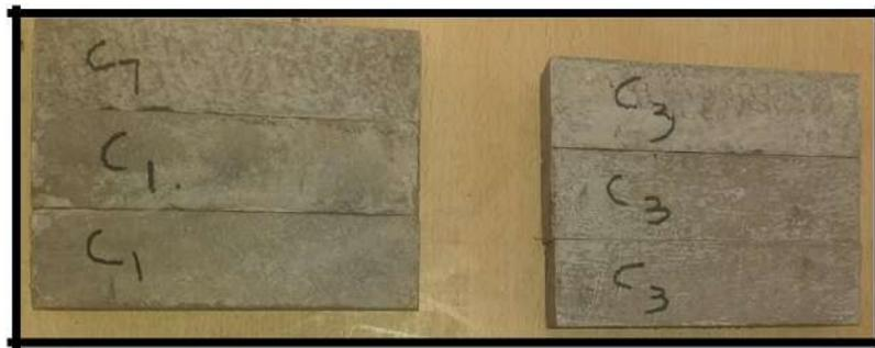
Photo III.10 Les éprouvettes après le démoulage
