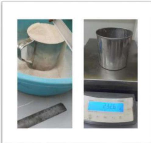
Photo II.1 La masse volumique apparente du sable concassé
