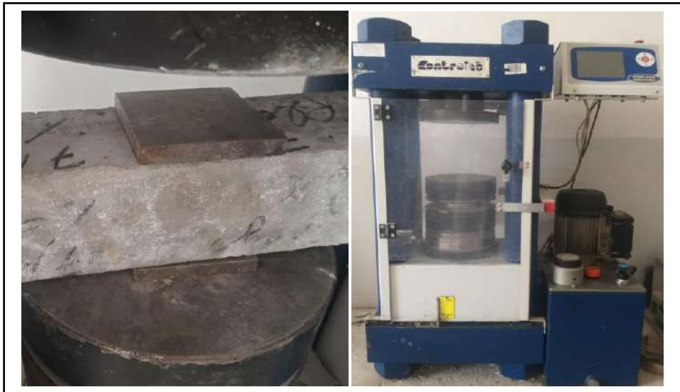
Figure (II.14) : Machine d'essai de compression.
