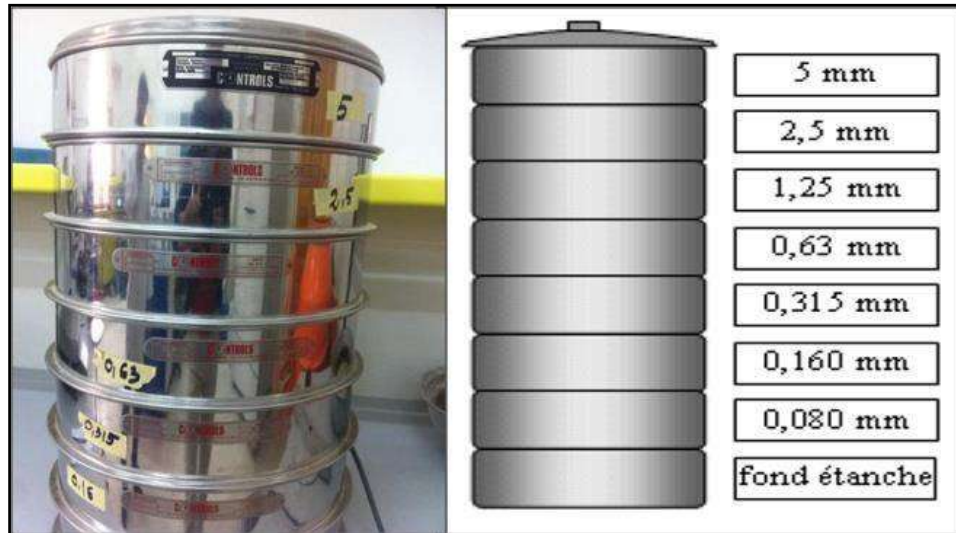
Figure (II.1) : Colonne de tamis.
