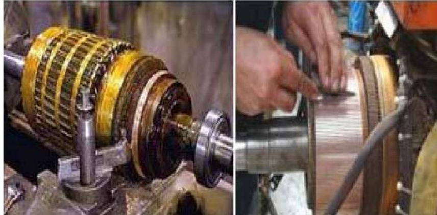
Figure I.4 : Composition de l'induit [1].
