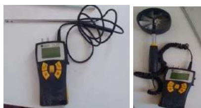
Figure II.8: Anémomètre à affichage numérique
