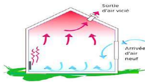
Figure I.3 : principe de circulation de l'air dans un habitant
