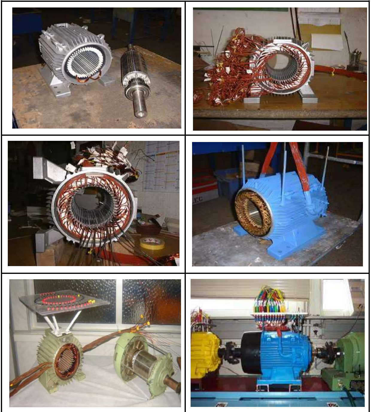
Photos du prototype de la machine asynchrone à double stator.
