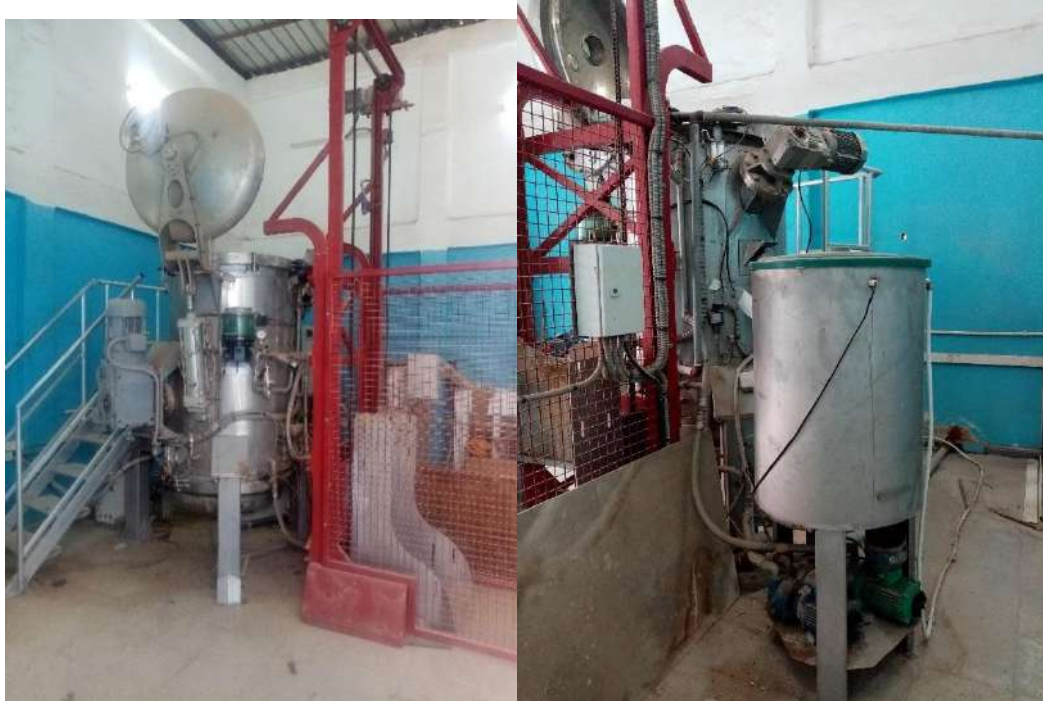
Figure II.5 : Banalyseur composé de quatre moteurs chaqu'un a une fonction spécifique
