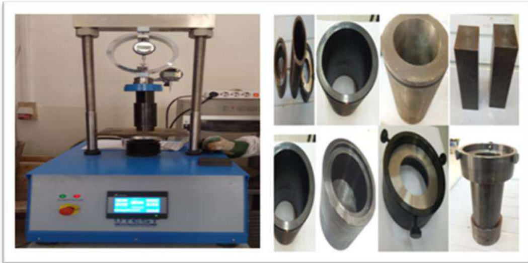
Figure ( II . 1) Presse et équipements de l'essai Hubbard Field
