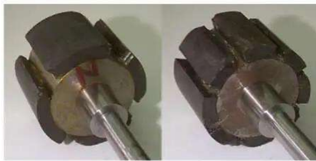
Figure (I. 7) . rotor à aimant permanent (4 pôles et 8 pôles )
