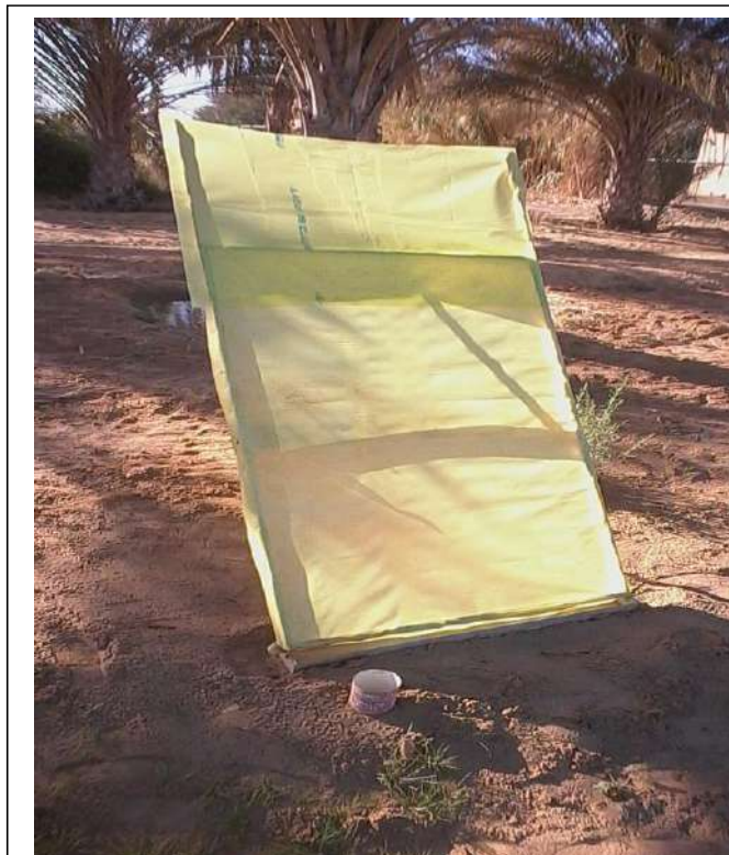
Figure (III.10). Schéma d'un capteur d'eau précipité hors la parcelle
