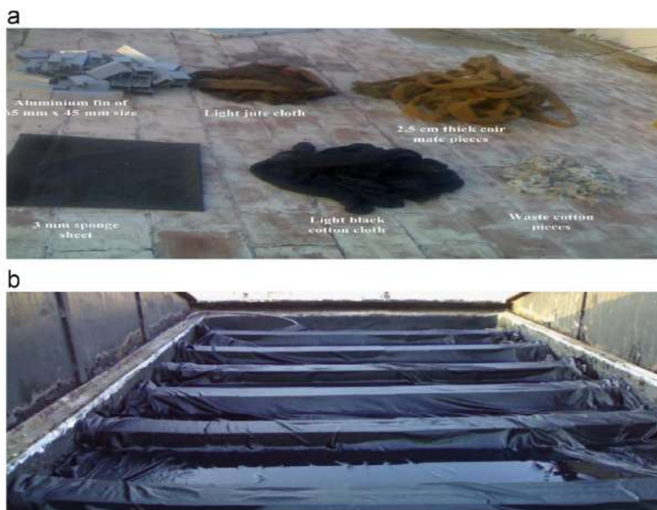
FIGURE 3.26 – Différents matériaux de mèche dans le bassin [106]
