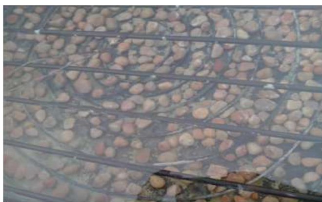
FIGURE 3.27 – bassin du distillateur avec pierre en béton [107]
