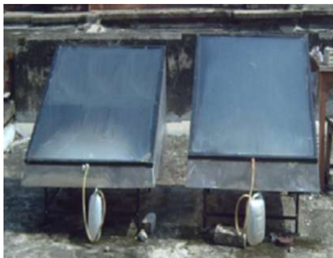
FIGURE 3.28 – Distillateur solaire conventionnel avec et sans PCM [108]
