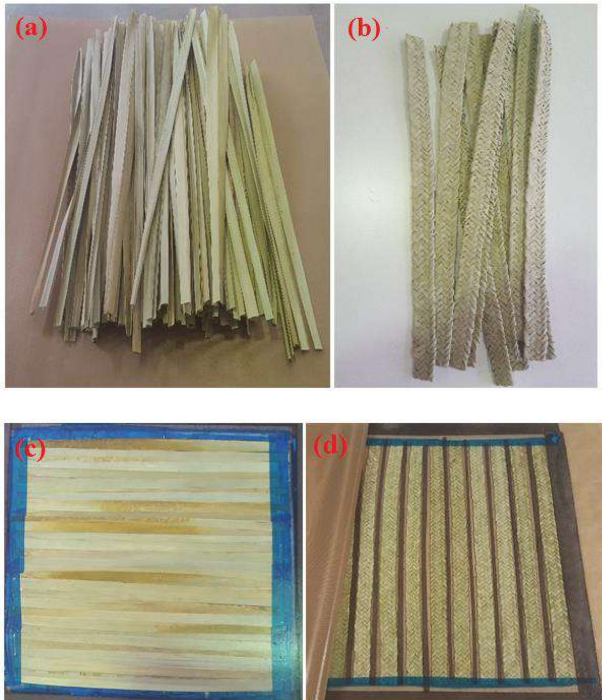
Figure II.4. Biocomposites constitués de fibres de palmier dattier : a) Foliolles b) cordons tressés, c) Plaque biocomposite stratifié (0/90)s, d) plaque en cordons tressés.
