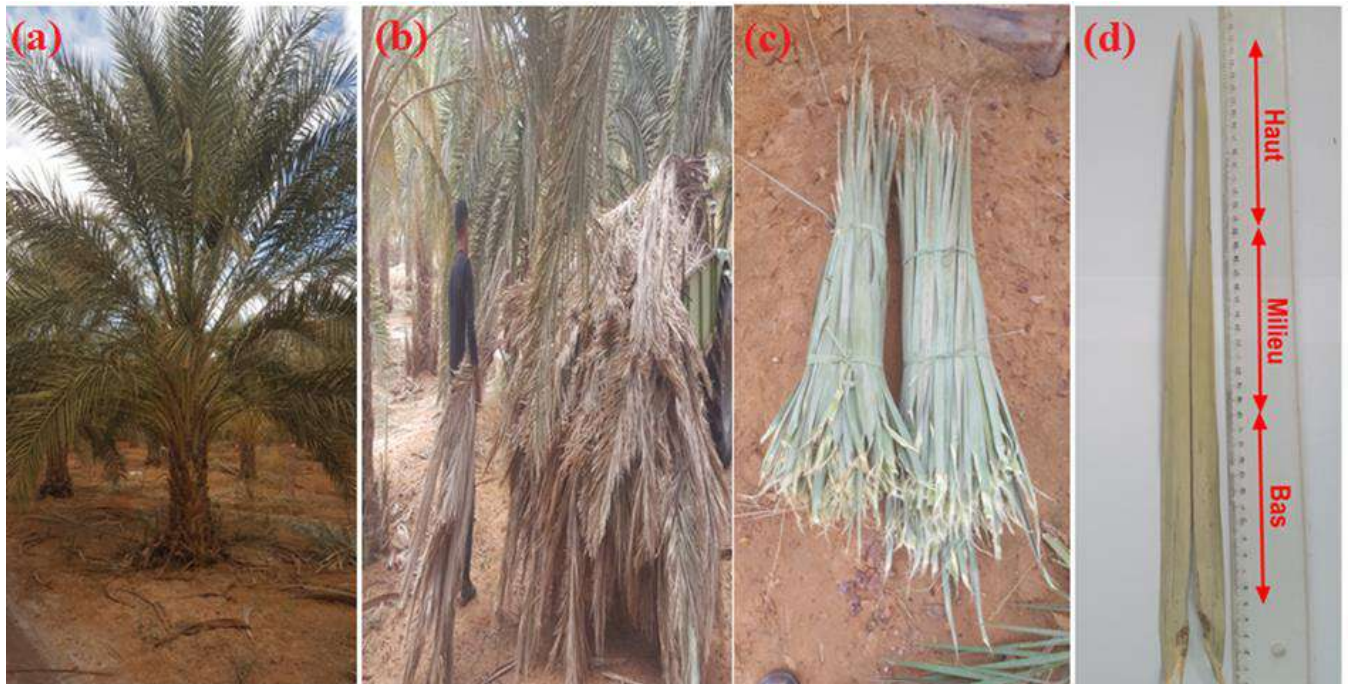
Figure II.1. Photographies de : a) Palmier dattier, b) Palm (appelé aussi Djerid), c) Folioles coupés, d) Folioles nettoyées, séchées et mesurées.
