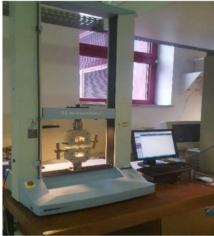
Figure II.11. Machine universelle de type Shimadzu, modèle Autograph AG-X (Université de Beira Interior Covilha, Portugal).
