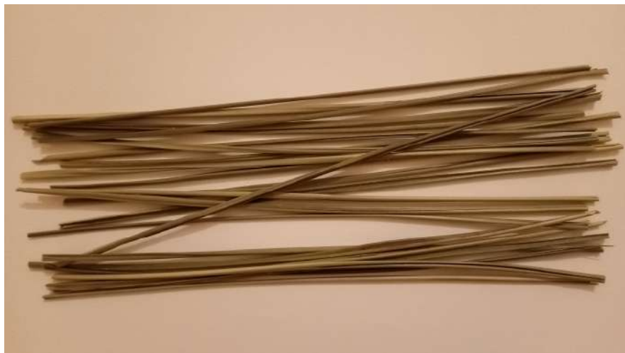
Figure II.6 Fibres de Diss sous forme d'éprouvettes pour essai de traction.
