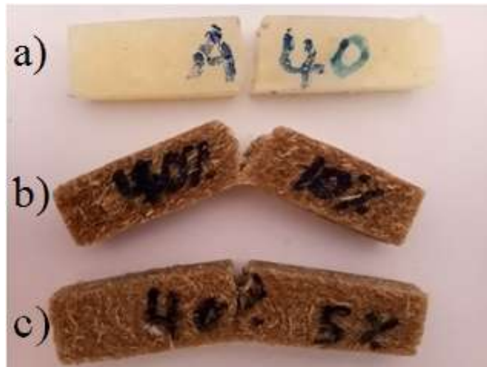
Figure III.6 Aspect macrostructure des éprouvettes (Glycérine à 40 %) avant et après renforcement déformées après l'essai de charpy (a : bio-plastique SG40, b : bio-composite SG40/RF5, c : bio-composite SG40/RF10).
