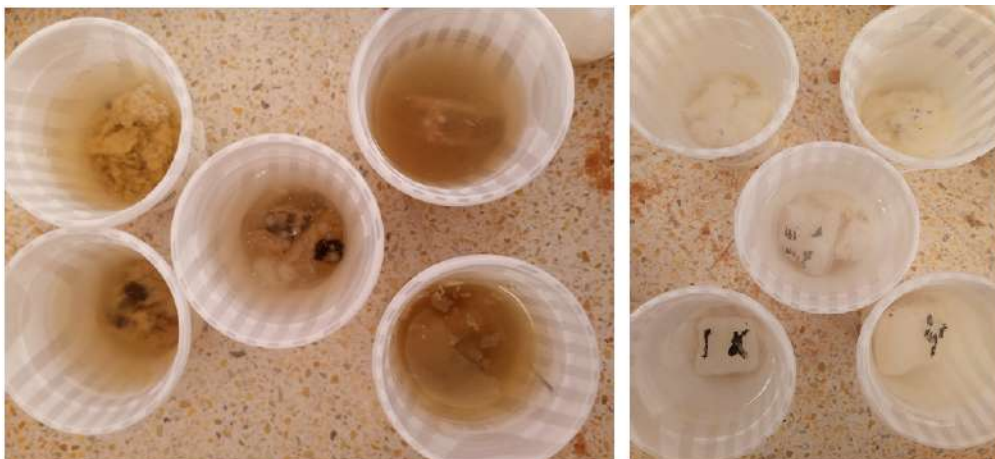
Figure II.12 Dégradation en milieu aqueux.
