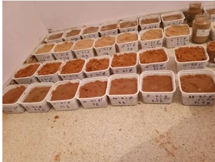
Figure II.11 Enfouissement dans le sol.
