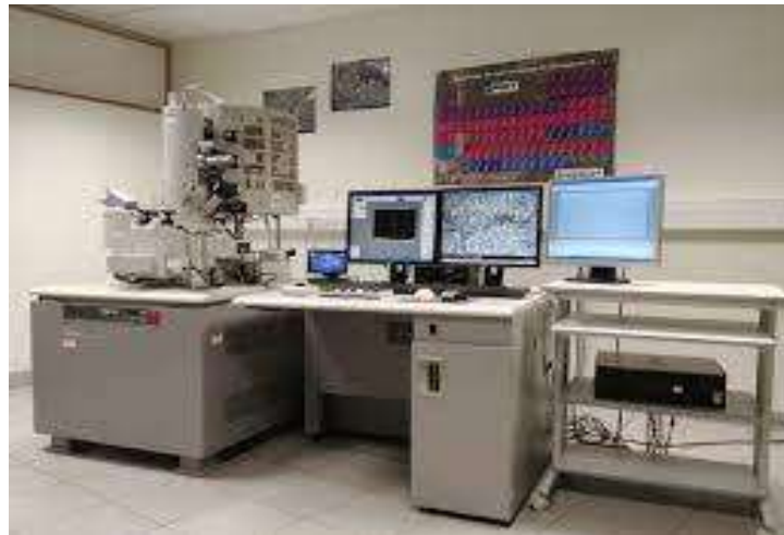
Figure II.3 Microscope à balayage électronique (MEB) model JSM-5600.
