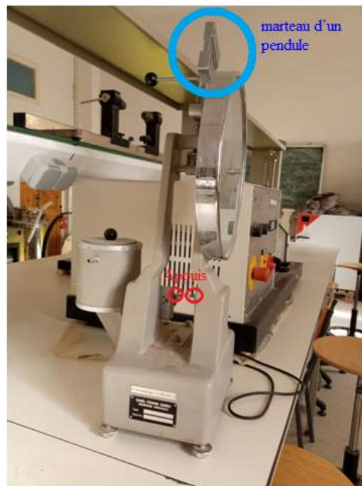
Figure II.9 Marteau d'un pendule et les appuis dans une machine à charpy.
