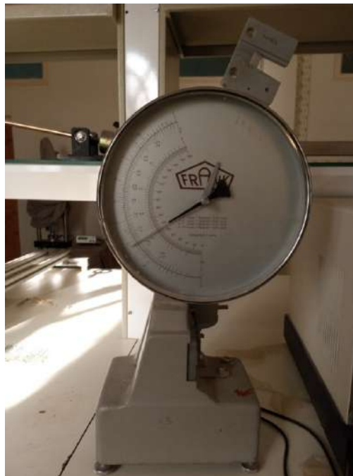
Figure II.10 Machine "Karl frank Gmbh Weinheim Birkenau" type "53565", avec un marteau 4J.
