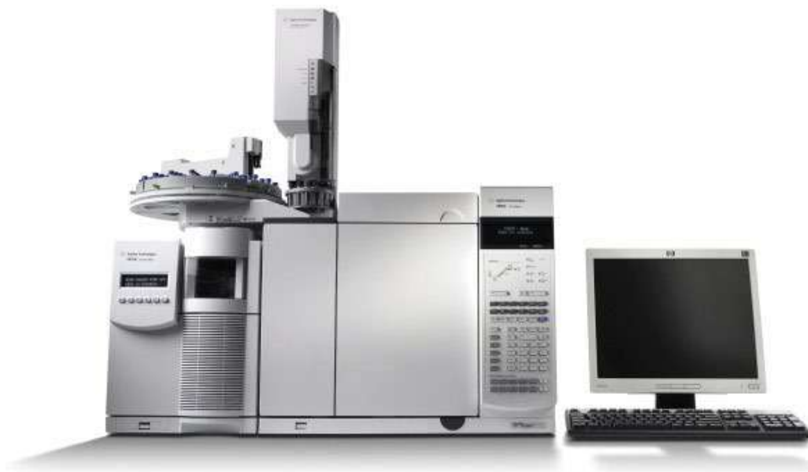
الشكل 2: جهاز كروماتوغرافيا الغاز GC-MS، من طراز GC-7890A/MS-5975C، اجيلنت لتكنولوجيات، سانتا كلارا، كاليفورنيا، الولايات المتحدة الأمريكية.
