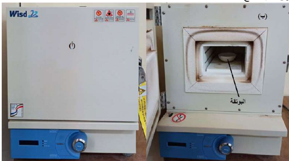
الصورة 5.3. توضح الجهاز المستعمل في هذه التجربة لقياس بقايا الكربون.
