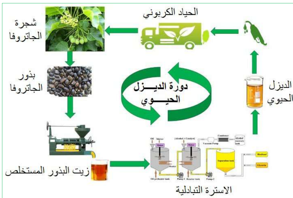
الشكل 4.2. رسم تخطيطي لتوضيح دورة الديزل الحيوي [190].
