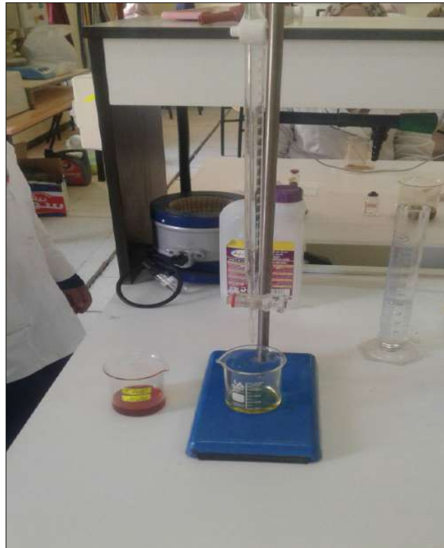
الصورة 3.3. معايرة قيمة الحمض (AV) والأحماض الدهنية الحرة (FFAs).
