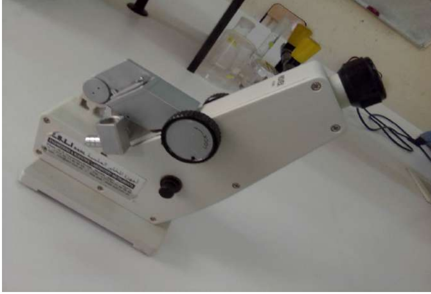
الصورة 2.3. جهاز مقياس الانكسار Abbe لحساب معامل الانكسار.
