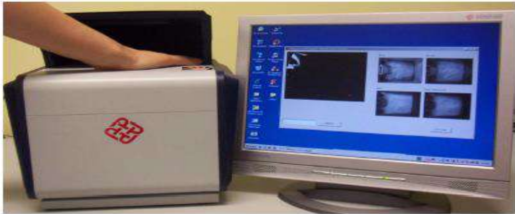
Figure III.6 – Structure externe d'un dispositif d'acquisition d'image palmprint multispectrale [85].
