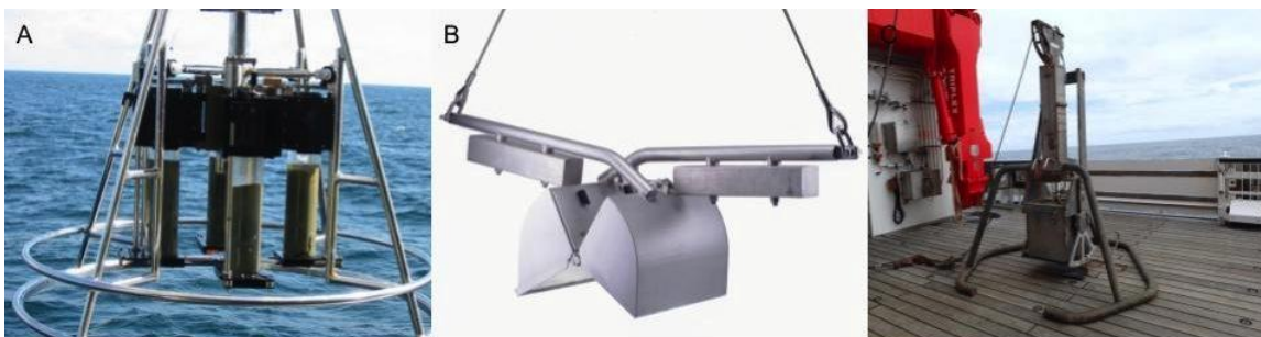
Figure II.6 : Systèmes de prélèvements de MP dans les sédiments marins. A) Carottier multi-tube. B) Benne de type Van Veen. C) Carottier boîte.
