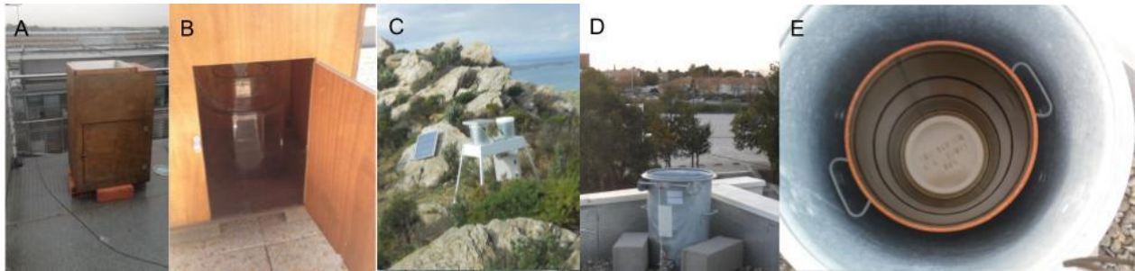
Figure II.1. Collecteurs de dépôt atmosphérique. A-B) système avec un récipient en verre surmonté d'un entonnoir, utilisé sur un toit de Paris [1]. C) échantillonneur humide et sec (MTX). D-E) collecteur simple.
