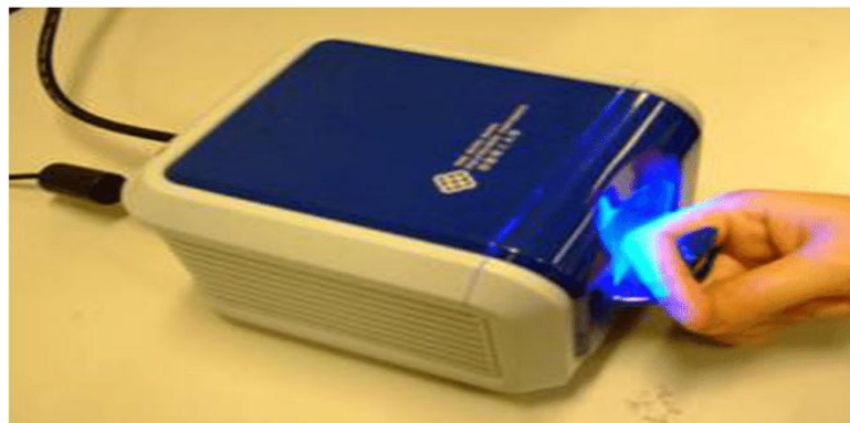
FigureII. 1 : capteur d'Acquisition d'images FKP
