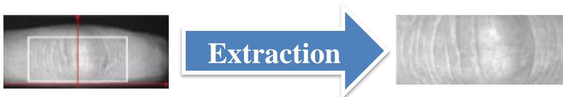
Figure II.10: Extraction de la ROI à partir de l'image de doigt.
