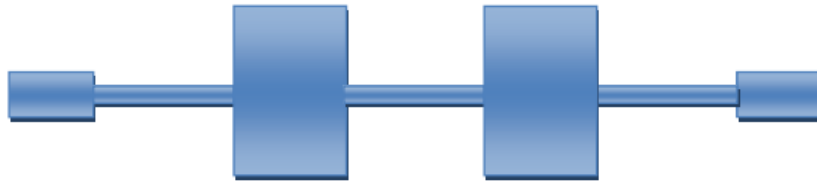
Figure I.11 : Structure d'un filtre passe-bas à saut d'impédance en technologie micro ruban
