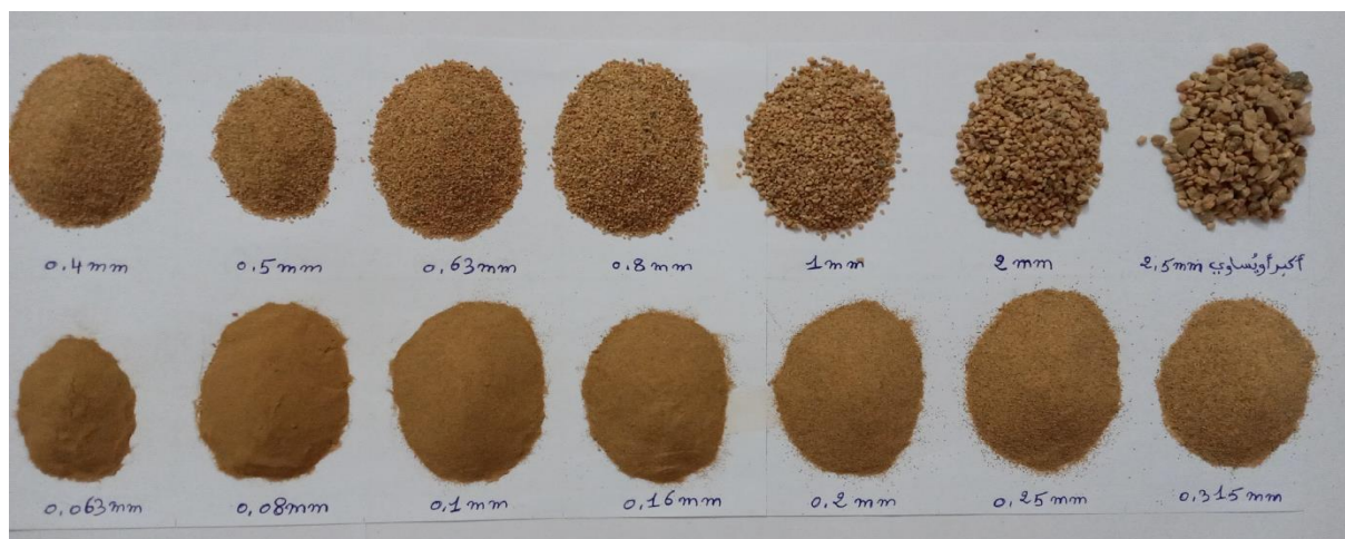
الشكل II-8: تصنيف الحبيبي لحبات لعينة رمل منطقة تامنغست وبقال USDA .
