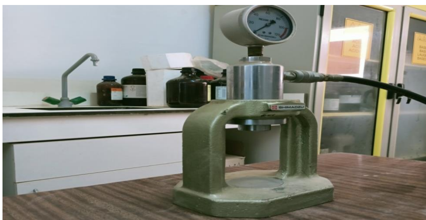
الشكل II-11: صورة لجهاز الضغط المستخدم في تقنية FTIR.
