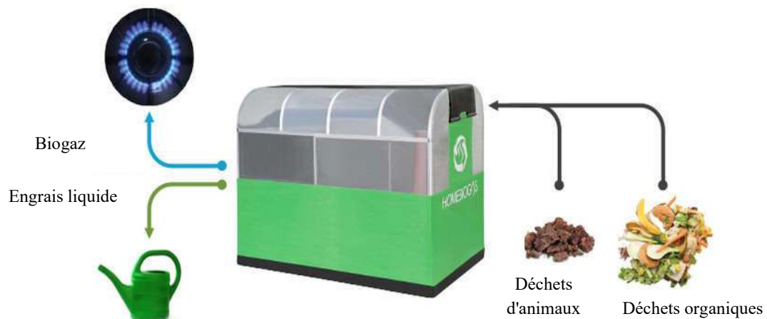
Figure 1. 12 Processus de méthanisation par le déchet organique/animale
