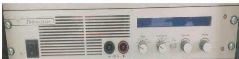
Figure 5. 6 Charge EL-2400 électronique utilisée, qui peut être fonctionné par l'intermédiaire des signaux analogiques issus par l'interface LabVIEW
