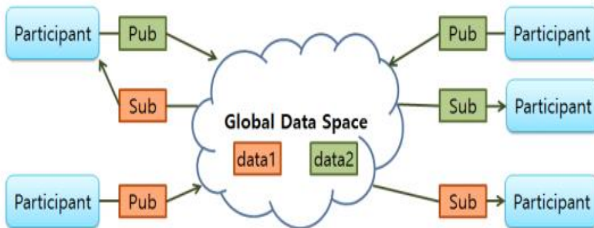
Figure 2.2 Modèle de communication DDS [44]
