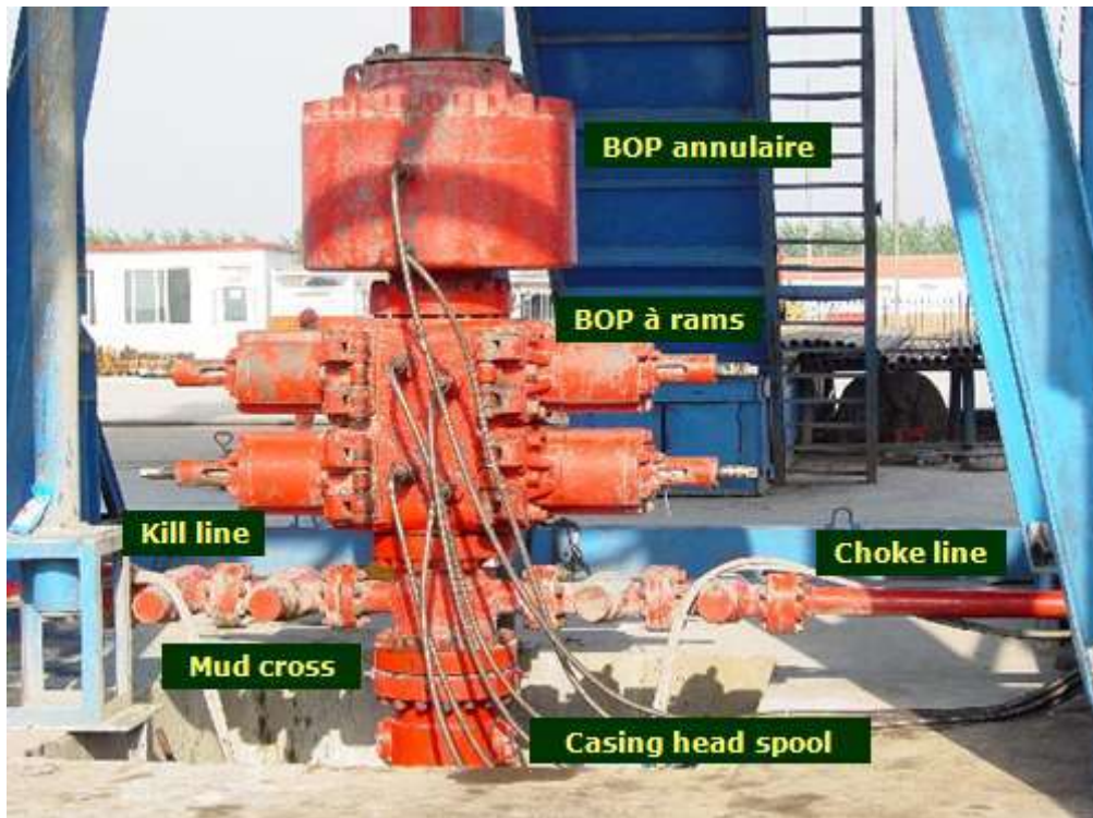
Figure I.8 : Système des obturateurs
