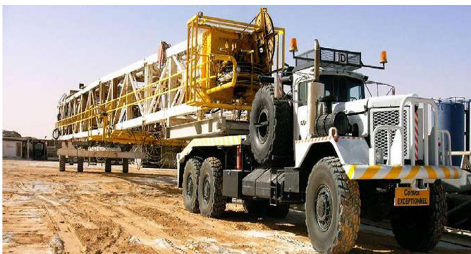
Figure (6): Phase de transport d'un appareil de forage.
