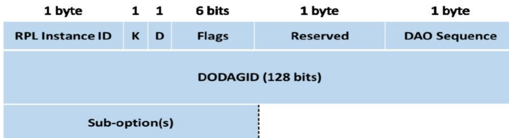
Figure 11: Structure du message de contrôle DAO[18].
