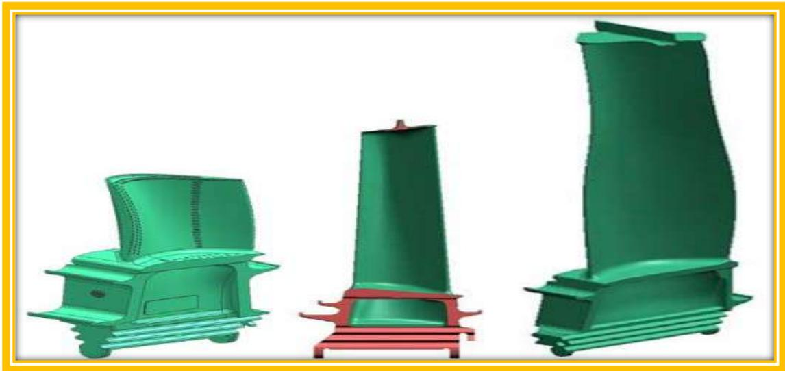
*Figure. II. 25. Bis. Les aubes des 3 étages turbine*
