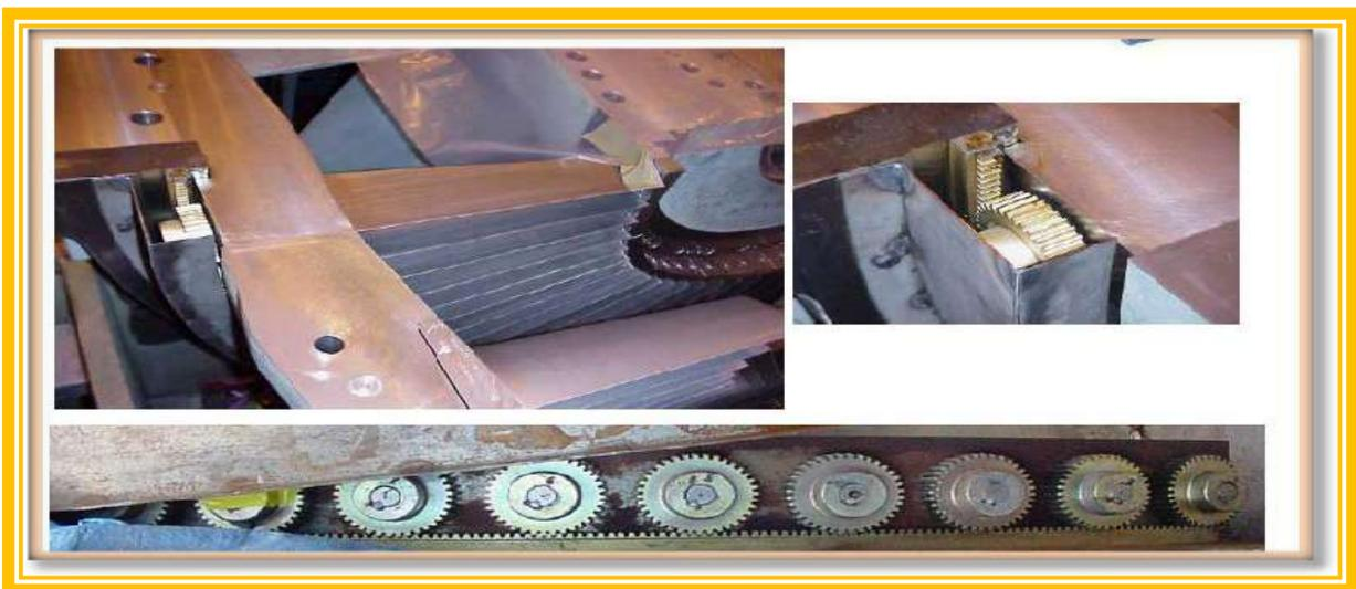
Figure. II.13. Aubes orientables I.G.V de la TG MS 9001e
