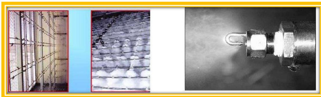
Figure IV.11: Refroidissement par atomisation ou pulvérisation d'eau
