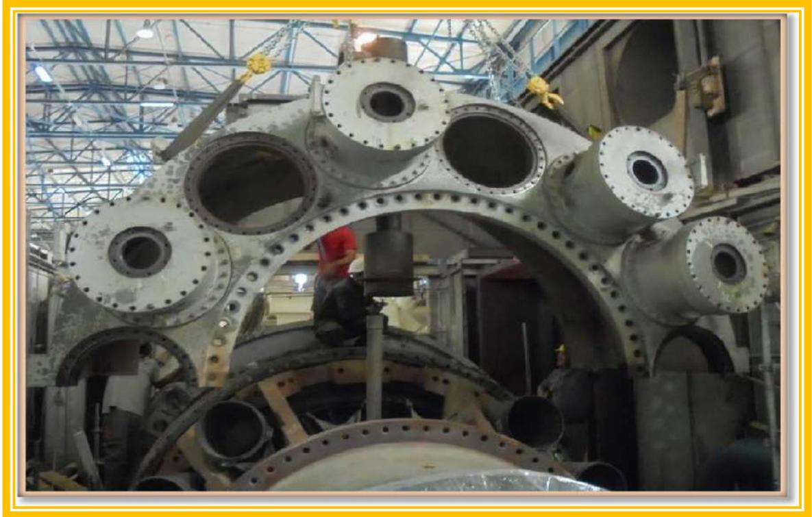
***Figure. II.18. Carter des chambres de combustion***
