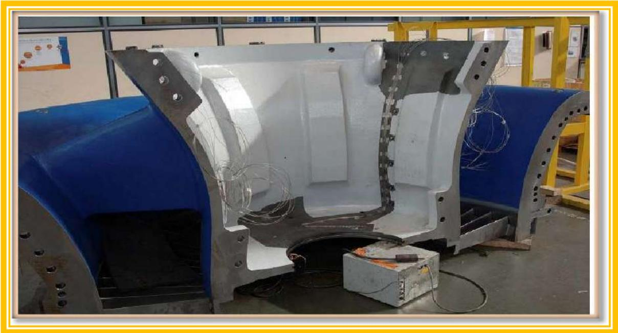
Figure. II.12. Corps d'admission compresseur de la TG MS 9001e
