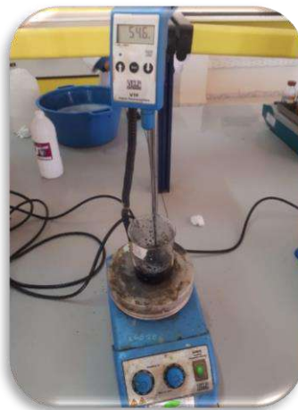
Figure (III-2) : Montage expérimental utilisé dans cas d'adsorption sur charbon actif.
