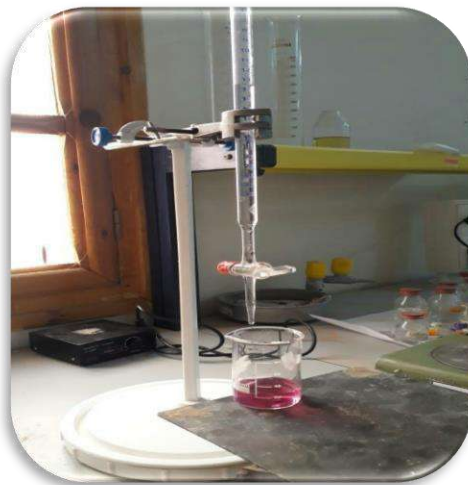
Figure (III-3) : Montage expérimental utilisé du dosage acido-basique de l'acide acétique
