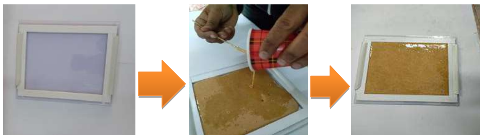
Figure III.13 : Moulage des plaques.
