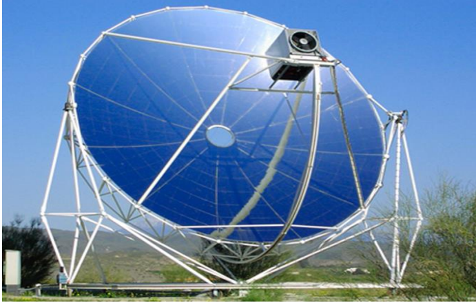
الشكل (2-15): مركز شمسي على شكل قطع مكافئ.
