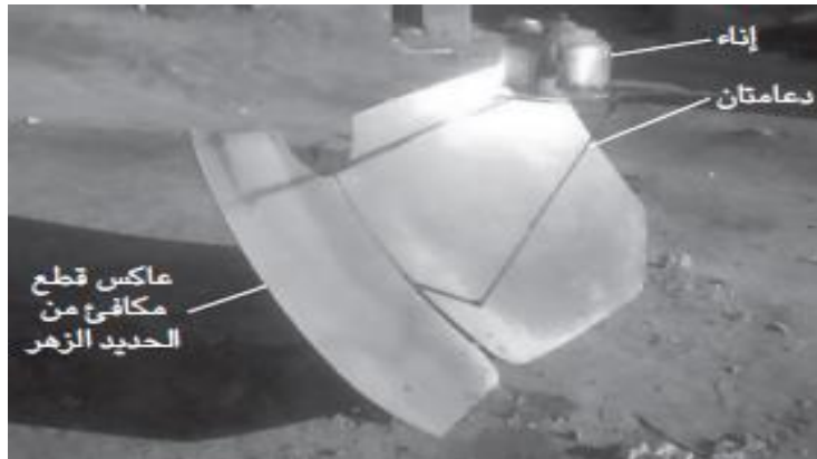
الشكل (2-12): فرن شمسي.
