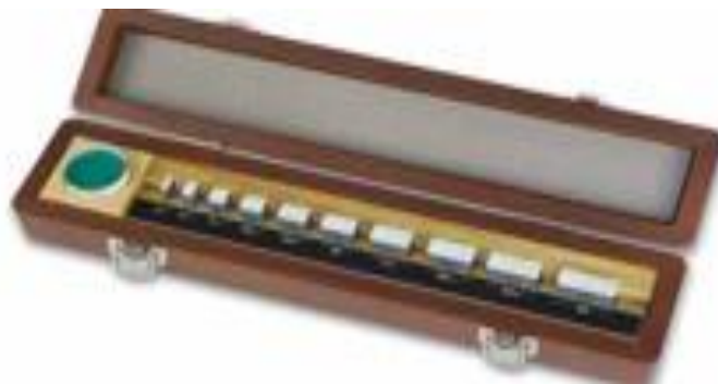
Figure IV.4 Boîte de cales étalons pour étalonnage des micromètres d'extérieur
