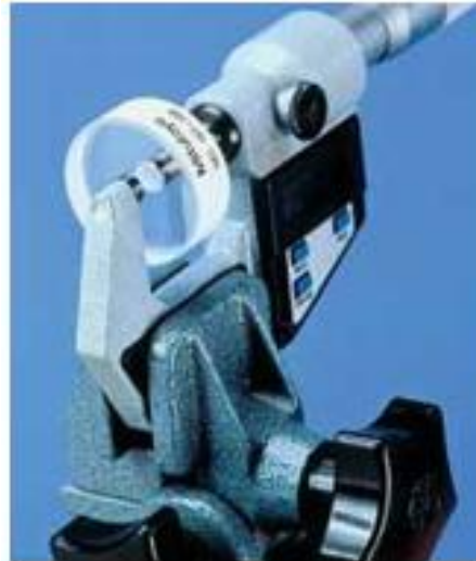
Figure IV.8 Positionnement du verre plan parallèle entre les deux faces de mesure
