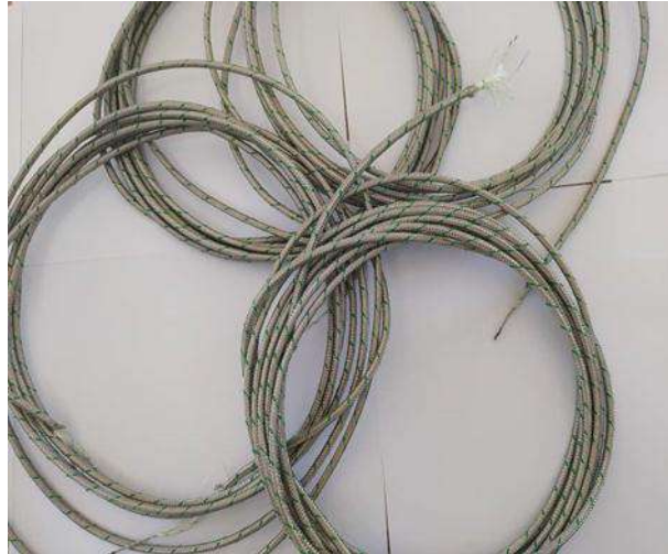
Figure.III. 4. Thermocouples type K utilisés dans l'EAHE system
