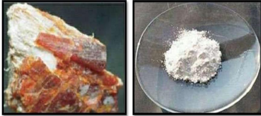
**Figure.I. 3.** Oxyde de zinc (ZnO) massif sous forme naturelle(a) et poudre(b)
