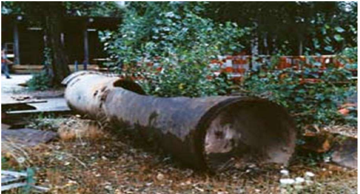
Figure I-1 : Un gazoduc éclata à Natchitoches en Louisiane en provoquant un incendie qui causa la mort de 17 personnes.
