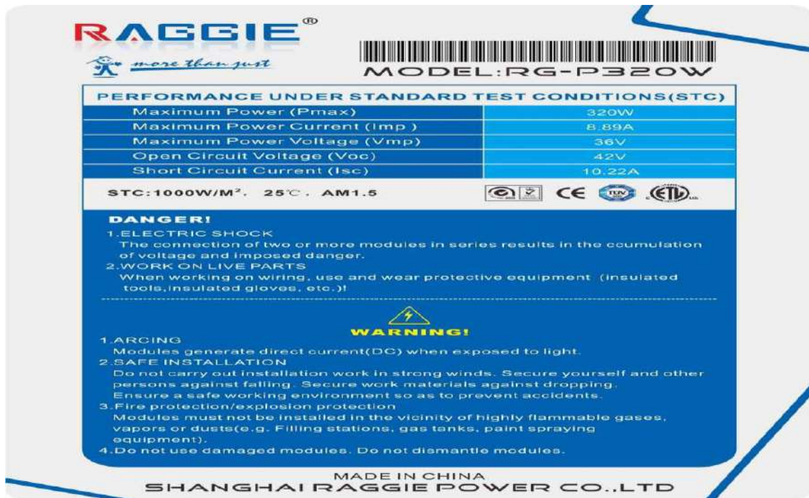
Figure III.5 : Fiche technique de panneau photovoltaïque.
