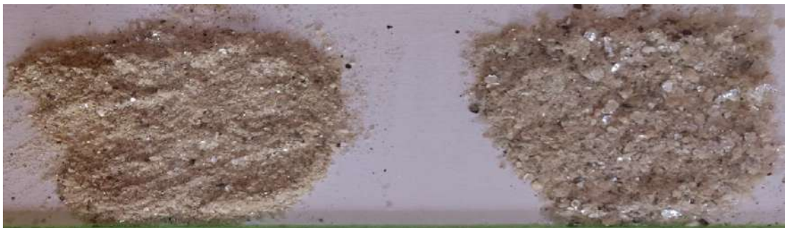
Figure III.5: Photographie de colmatant floconneux mica fine (à gauche) et coarse (à droite)
