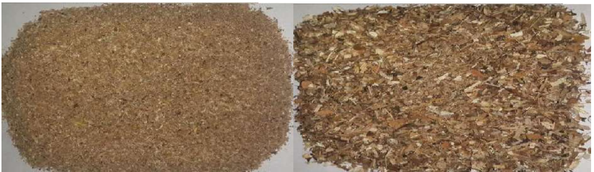
Figure III.6: Photographie de colmatant fibre, cellulose fine (à gauche) et coarse (à droite).
