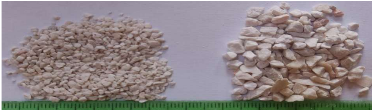
Figure III.4 : Photographie de colmatant granulaire (caco3) medium et coarse.
