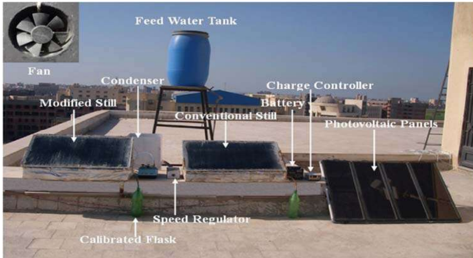
الشكل (2-57): صورة للتركيب التجريبي لمقطر شمسي مرتبط بمكثف خارجي (Kabeel et al. 2014).
