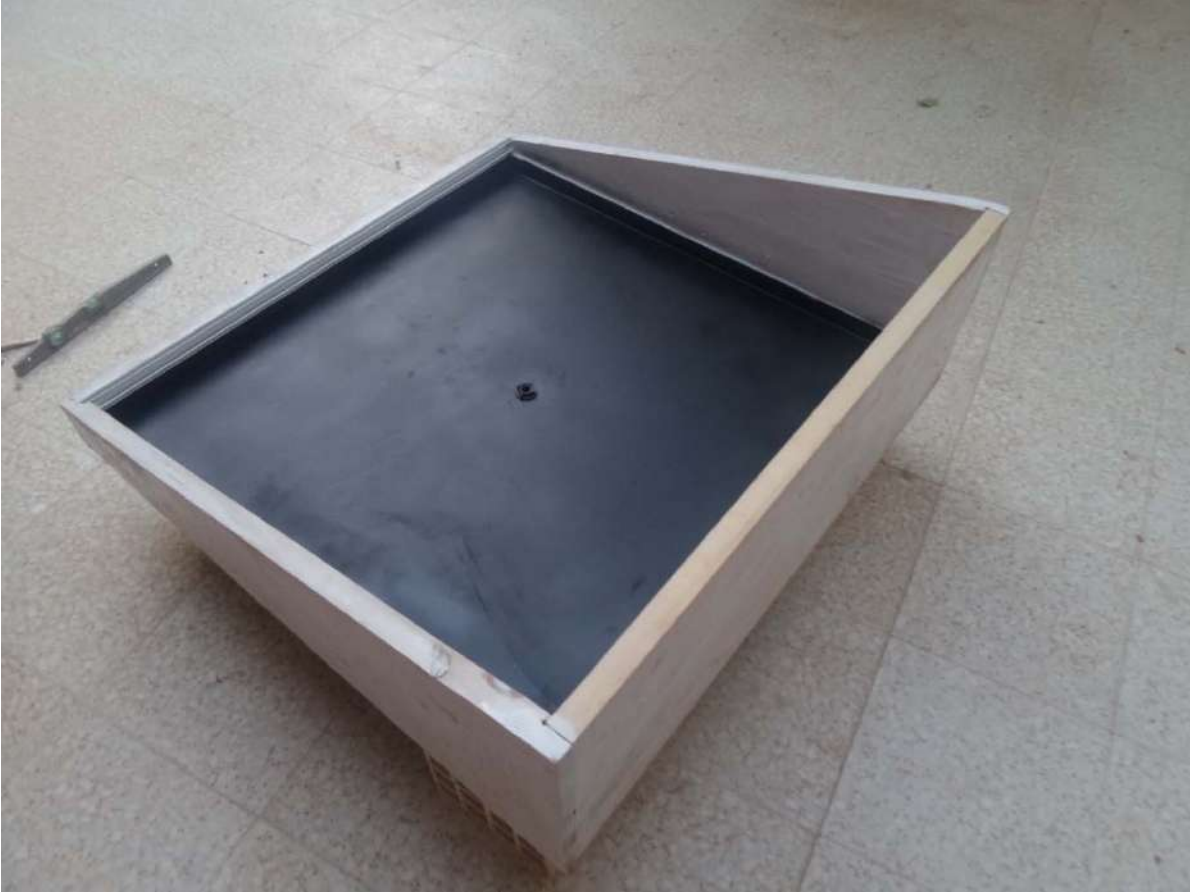
الشكل (3-5): نظرة عامة للحوض 1 بالتجربة الأولى باستعمال المقطر (SSS) و (HP)
