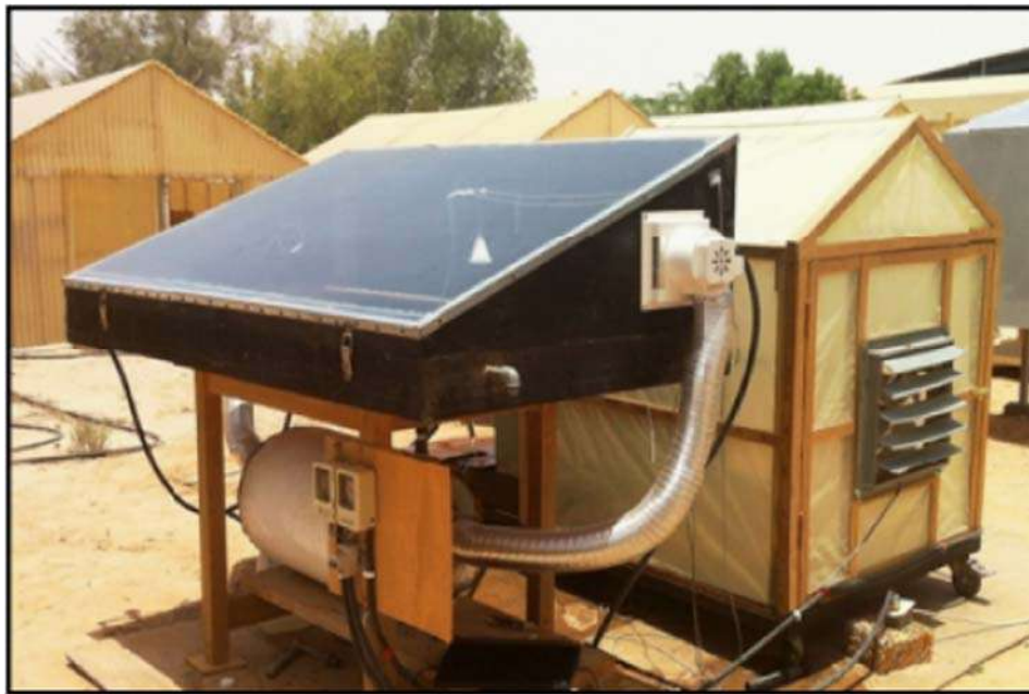
الشكل (2-58): صورة للتركيب التجريبي لمقطر شمسي مرتبط بمكثف خارجي (Almuhanna 2014).
