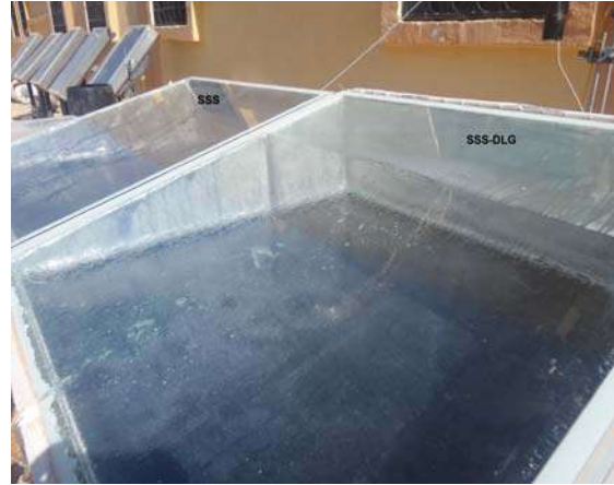
صورة توضح المقطرين معا أثناء عملية التقطير، حيث يظهر ماء التبريد بين الطبقتين الزجاجيتين
